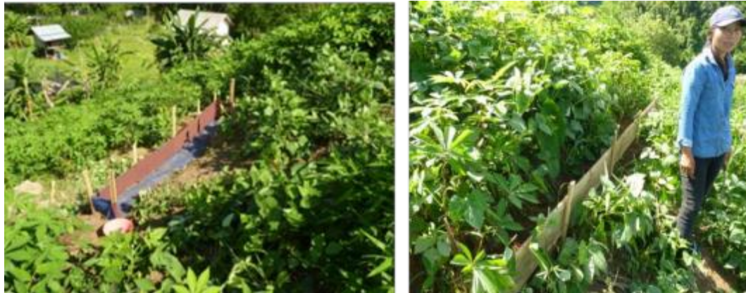
Figure 13 : Dispositif de suivi de l'érosion installé au centre technique de Muang Mouay en juillet 2016 (Gauche : barrière à sédiment et tranchée de collecte, Droite : barrière)
